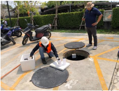
บ่อพักน้ำสุดท้ายก่อนระบายออกสู่ท่อรับน้ำทิ้งสาธารณะ
